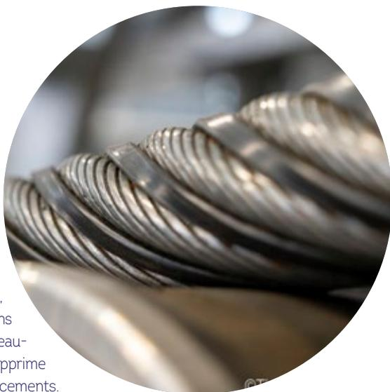
Le câble qu'il soit porteur ou tracteur, est fabriqué en France par Arcelor. Technologiquement très avancé : les espaces vides entre les "torons" (fils reliés entre eux) sont bouchés par des éléments plastiques. C'est la technique du "câble clos".
